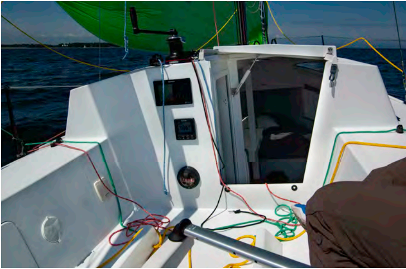
Der wuchtige Kajütaufbau bietet einen guten Schutz gegen überkommende Gischt. GFK-Keile am Cockpitboden geben den Füßen Halt – sie können im Hafen weggenommen werden.
