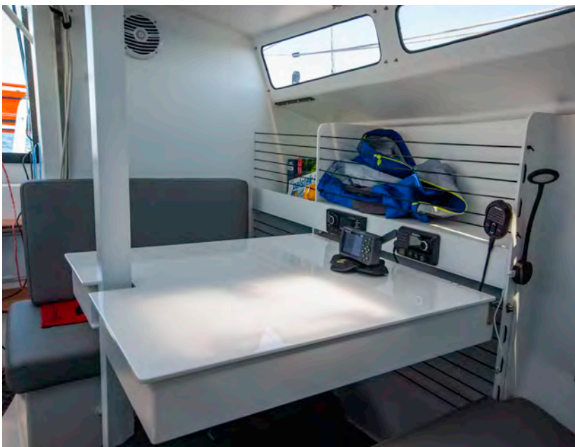
Die Messe ist als Dinette ausgelegt. An den Regalen fungieren Gummistrops als Schlingerleisten.
