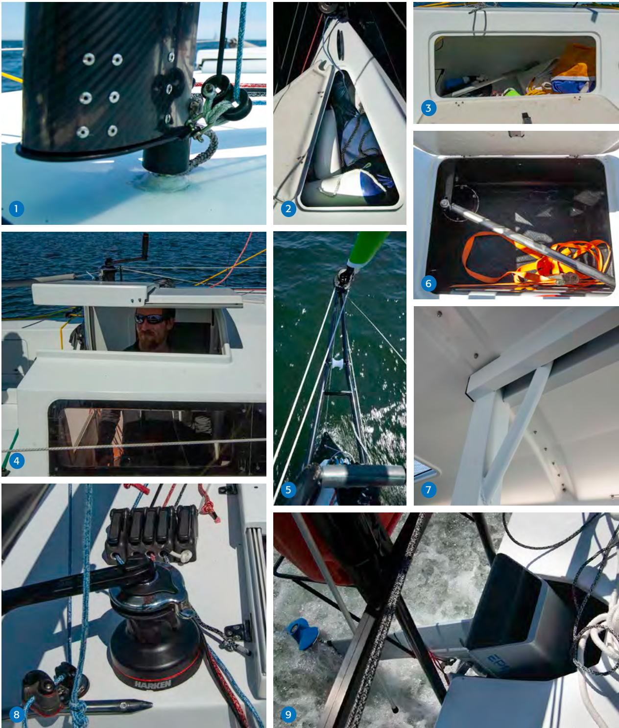
Details: 1.: drehbar gelagertes Rigg; 2.: geräumiger Ankerkasten im Vordeck; 3.: Cockpit-Backskiste mit seitlichem Zugang; 4.: stufenlos aufstellbare Niedergangsabdeckung; 5.: abklappbare Bugnase mit integrierter Ankerrolle; 6.: heckwärtiges Staufach mit Zugang zum Rudergestänge; 7.: Träger zur Aussteifung des Kajütdachs (bei aufgehohlem Kiel); 8.: zentrale Deckswinch mit Stopperbank und drehbare Klemme für die Schot der Selbstwendefock; 9.: Aussparung für Außenbordmotor am Heck (mit Elektroaußenborder ePropulsion Navy 3.0).
